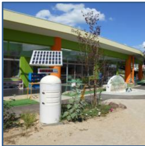
放射線量測定器設置
